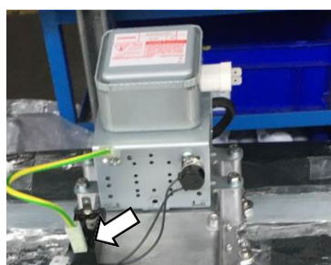
Une diode haute tension (modèle 1000 W e2s)
